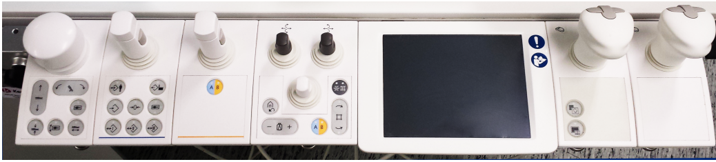
Abbildung 2.1: Verschiedene Module des Schaltpults am Operationstisch eines Artis Q Angiographiesystems von Siemens [23], Institut für Neuroradiologie, Universitätsklinikum Magdeburg.
