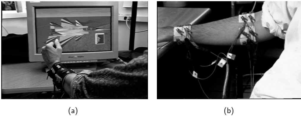
Abbildung 2.4: Konfigurationen für unterschiedliche myoelektrische Steuerung. a) zeigt den Aufbau der ersten Studie mit entwickeltem Ärmel zur Kontrolle eines virtuellen Steuerknüppels eines Flugsimulators. b) zeigt die aufgeklebten Elektroden die zur Erkennung von Tastatur Anschlägen genutzt wurden. (Quelle: [31])
