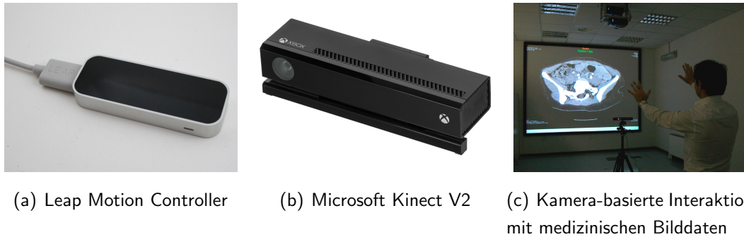
Abbildung 2.6: Die Abbildungen (a) und (b) zeigen den Leap Motion Controller [37] und eine Microsoft Kinect V2 [38], die für ein Kamera-basiertes System im Operationssaal in Frage kommen. Abbildung (c) (Bildquelle: [8]) zeigt eine Anwendung, die mittels Kinect eine Interaktion mit medizinischen Bilddaten umsetzt.
